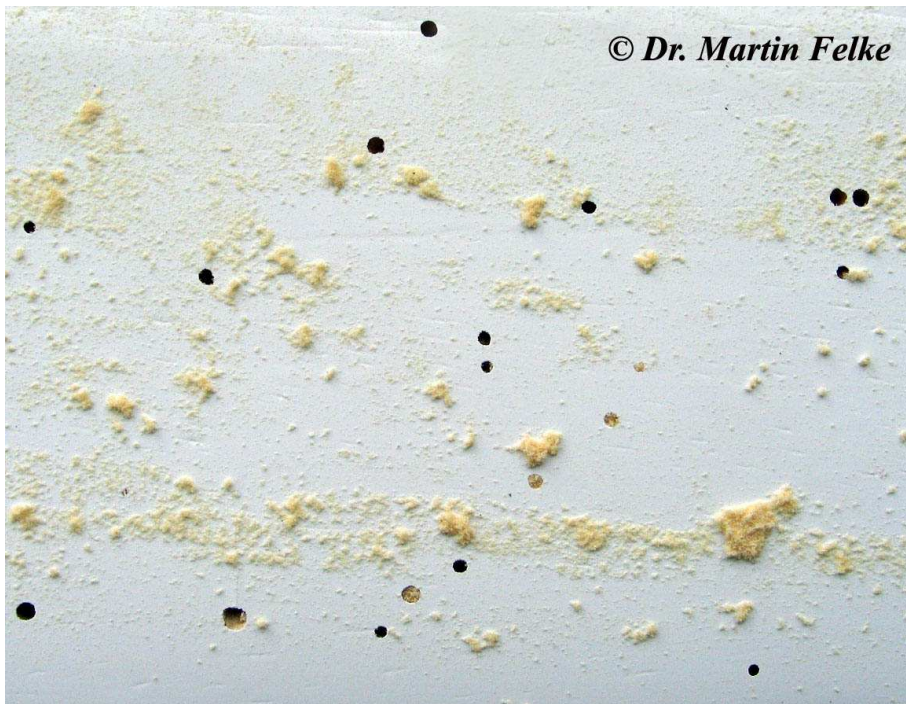
Abbildung 2: Befallenes Holz mit den typischen Ausfluglöchern
